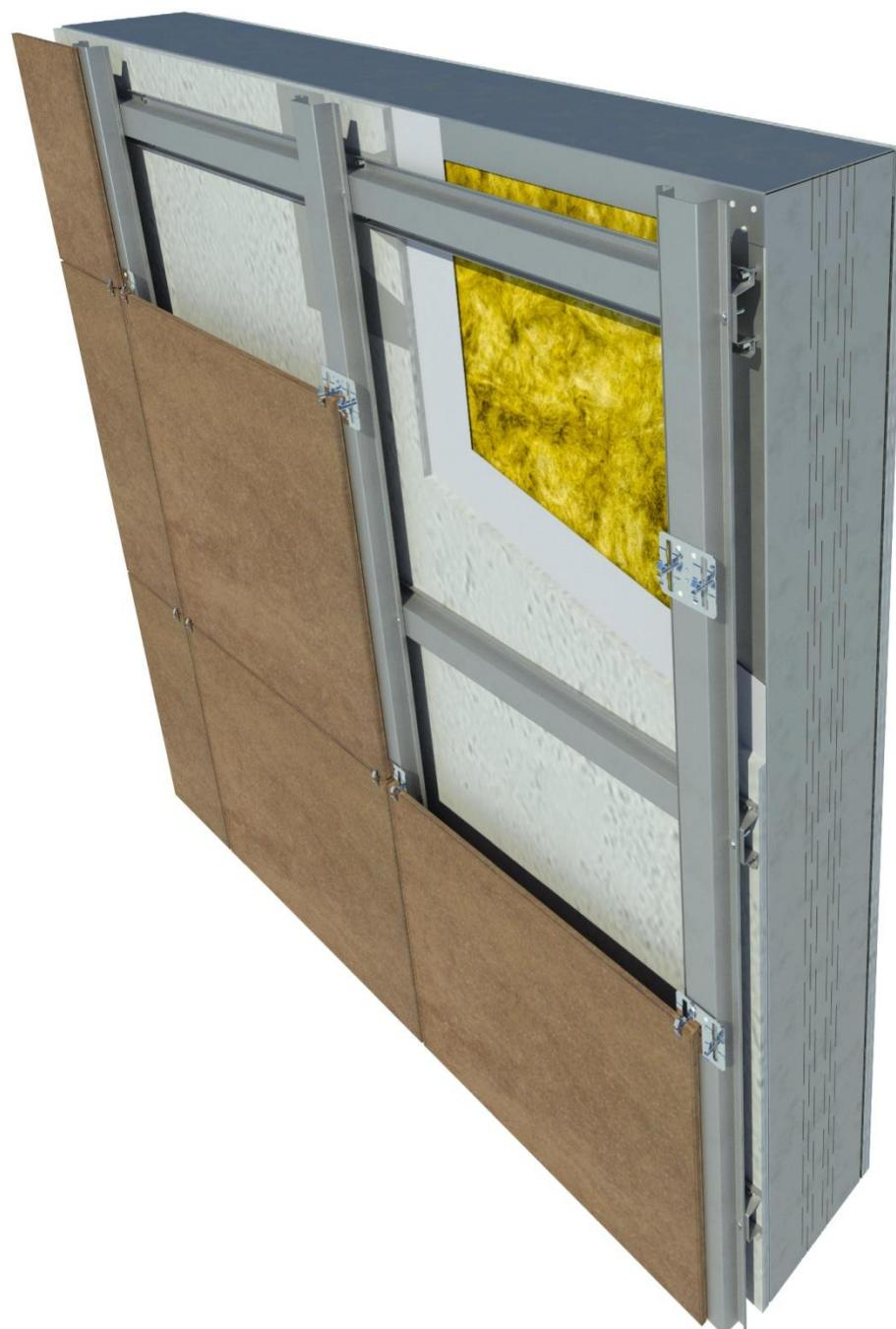
Рис.3 Общий вид наружной КОС Тип-3
