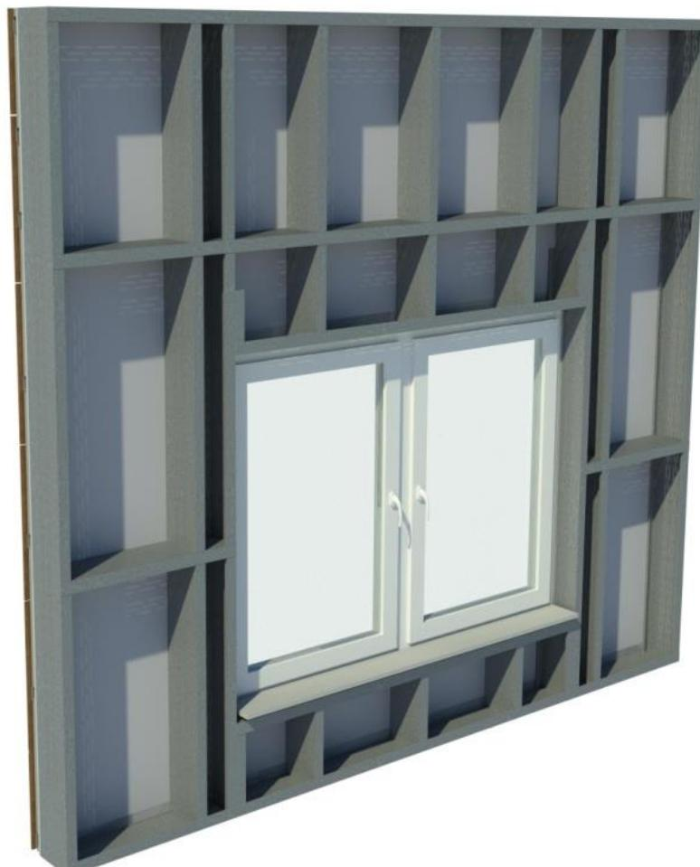
Рис. 1 Общий вид панели частичной готовности
