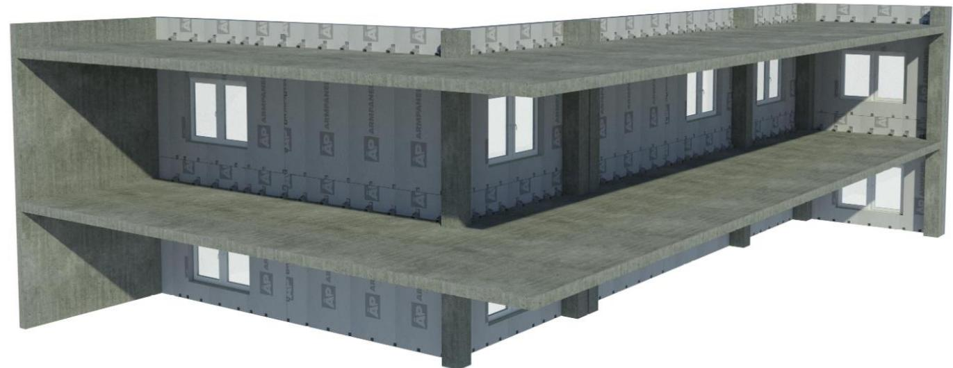
**Рис. 14** Общий вид панелей КОС полной готовности на фрагменте здания с внутренней стороны
