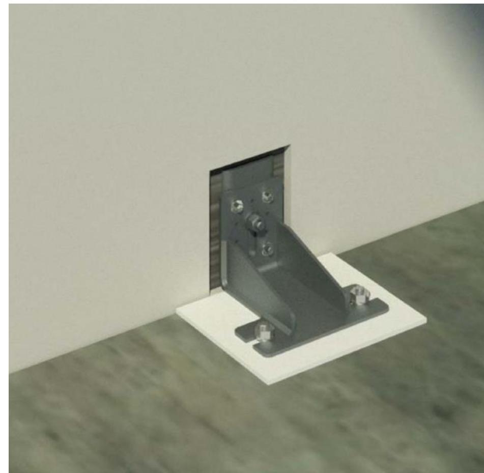
Тех. рис. 25 Схема крепления панелей КОС к ж.б. перекрытию возле промежуточной колонны. Стыковка двух смежных панелей в уровне перекрытия. Вид в плане к рис. 16
