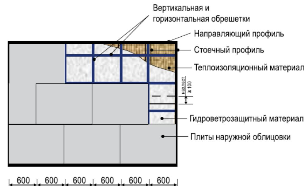
В области оконного или дверного проема должны исключаться сквозные горизонтальные швы. Вертикальные стыки должны располагаться над проемом на промежуточной стойке.
